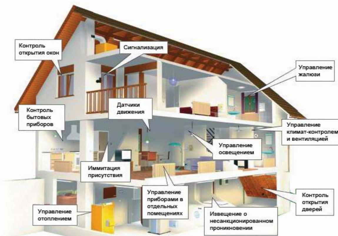
Рис 3.1.1. Элементы управления системой «Умный дом»
